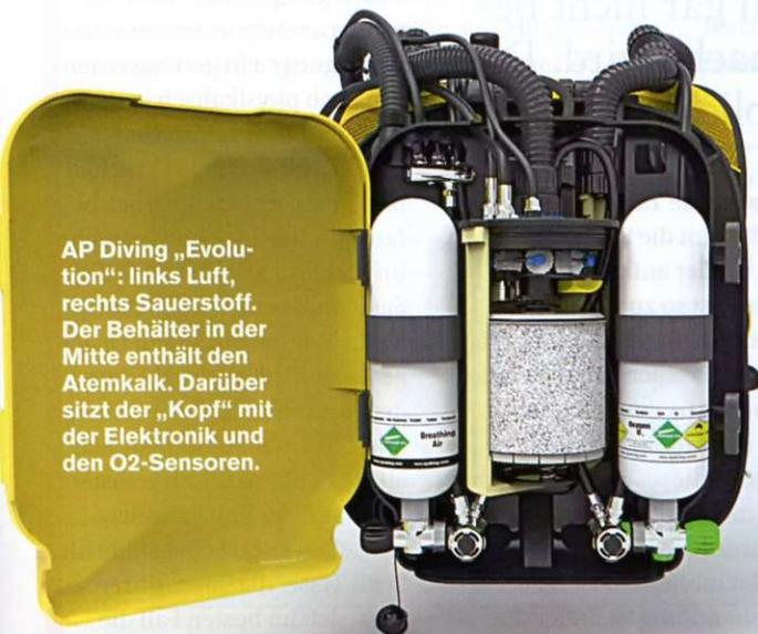
AP Diving „Evolution“: links Luft, rechts Sauerstoff. Der Behälter in der Mitte enthält den Atemkalk. Darüber sitzt der „Kopf“ mit der Elektronik und den O<sub>2</sub>-Sensoren.
